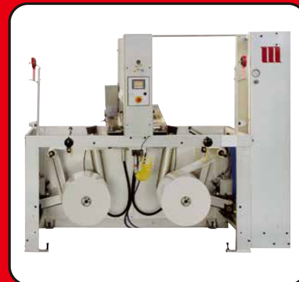
馬汀MBSC型對接式不停機自動放捲機 MARTIN MBSC AUTOMATIC BUTT SPLICER
