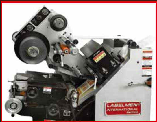
冷燙系統 COLD FOILING DEVICE
